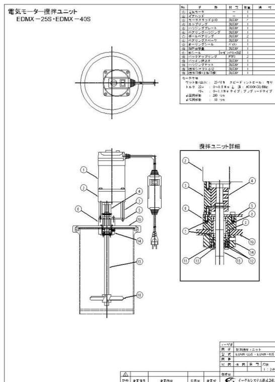
電気モーター式の攪拌ユニットで、モーター容量や形状とトルクの違いによって4種類の攪拌ユニットを用意しております。
